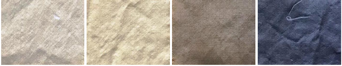
Şekil 4. Boyanmış %100 yün kumaş görüntüleri (Sırasıyla; Kontrol kumaş (mordansız), potasyum alüminyum sülfat (Şap), bakır sülfat ve demir sülfat mordanları kullanılmış)
