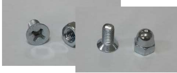
Şekil 12. Havşa Açılmış Torna Vida Başlı gümüş renkli M6’lık Cıvata ve Kapaklı(Kör) gümüş rengi M6’lık Somun
