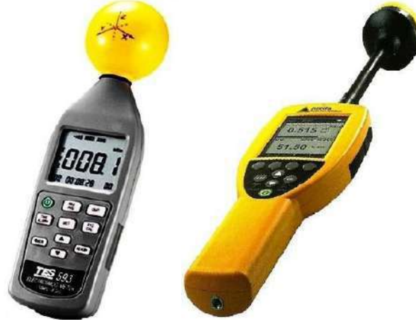
Şekil1.TES-593 elektromanyetik alan şiddeti ölçer (solda) ve NARDA NBM-550 elektromanyetik alan ölçer (sağda).
