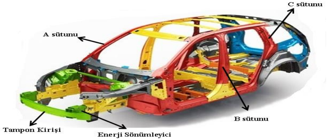
Şekil 1.1. Volvo firmasına ait olan aracın iskelet yapısı ve enerji sönümleyici elemanlar [2]
