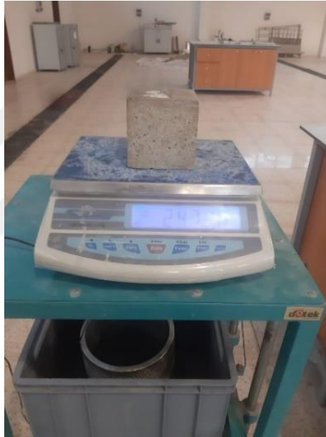
Şekil 3.11. Arşimet prensibi ile çalışan tartı
