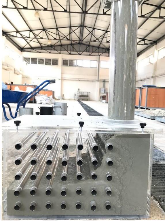
Şekil 3.8. Doldurma kutusu deney düzeneği
