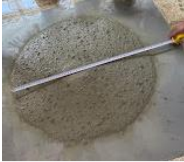
Şekil 3.3. Çökme yayılma deney düzeneği
