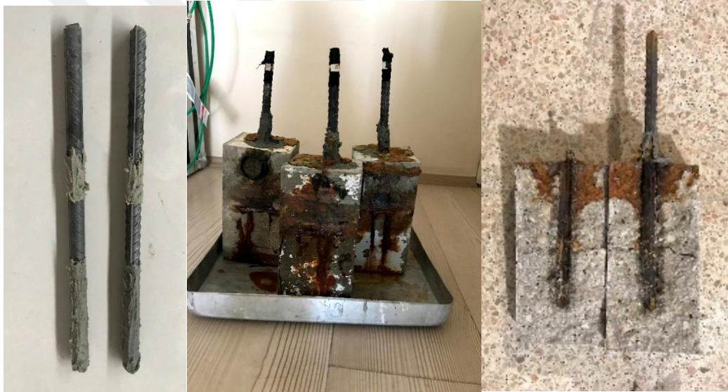
Şekil 3.18. Hızlandırılmış korozyon deneyi öncesi hazırlanan donatı ve deney sonrasında KYB numuneleri
