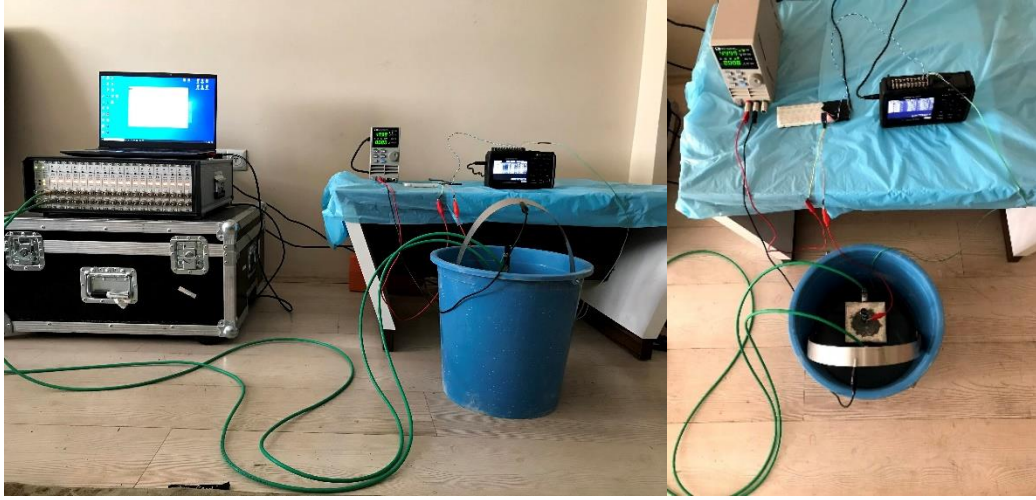
Şekil 3.17. AE yönteminin hızlandırılmış korozyon deney düzeneğine uygulanması
