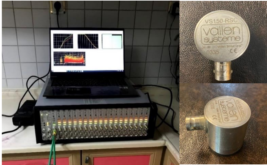
Şekil 3.19. 32 kanallı Vallen AE cihazı ve piezoelektrik sensör
