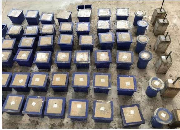
Şekil 3.2. Farklı boyutlarda kalıplara yerleştirilen deney numuneleri
