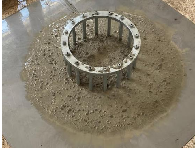
Şekil 3.4. J halkası deney düzeneği
