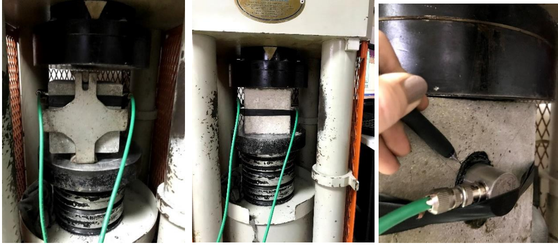
Şekil 3.20. Piezoelektrik sensörlerin KYB yüzeyine konumlandırılması ve kalem kırma yöntemi
