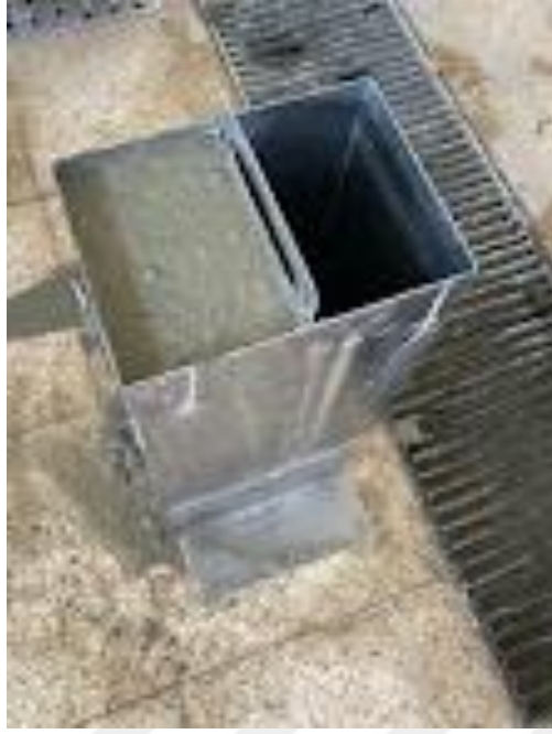
Şekil 3.7. U kutusu deney düzeneği
