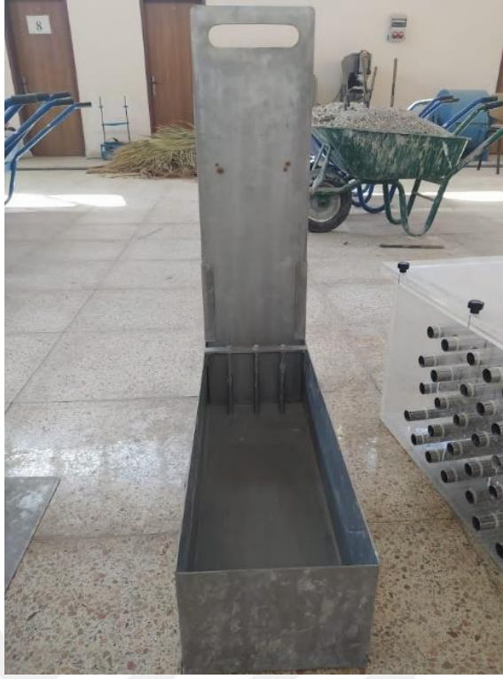
Şekil 3.6. L kutusu deney düzeneği
