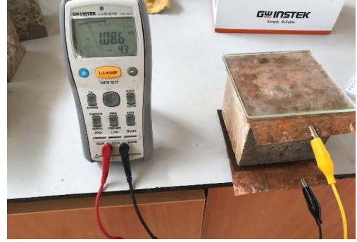
Şekil 3.15. Elektriksel özdirenç ölçüm düzeneği
