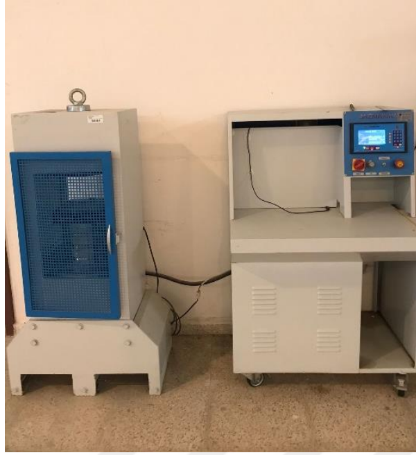
Şekil 3.9. Beton basınç presi
