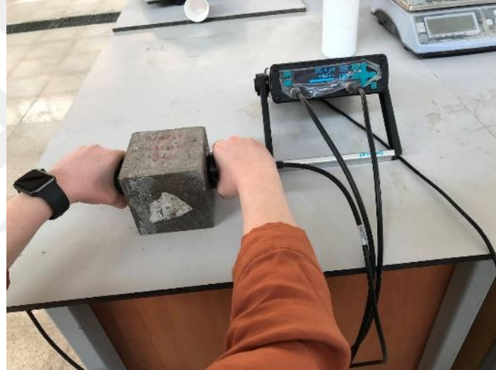
Şekil 3.14. Ultrases geçiş hızı deney düzeneği
