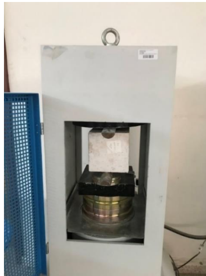
Şekil 3.10. Yarmada çekme deney aparatı
