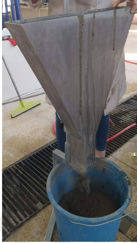
Şekil 3.5. V hunisi deney düzeneği
