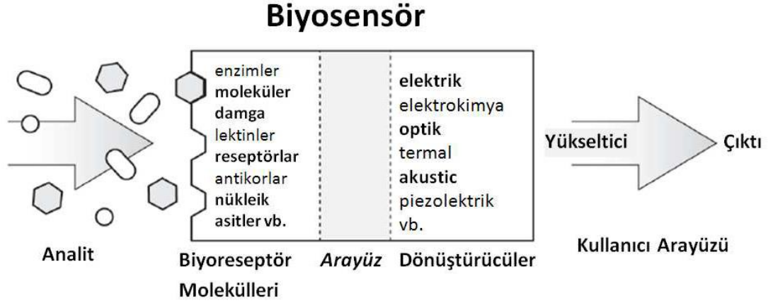
Şekil 1.12. Bir Biyosensörün Yapısı ve Bileşenleri
