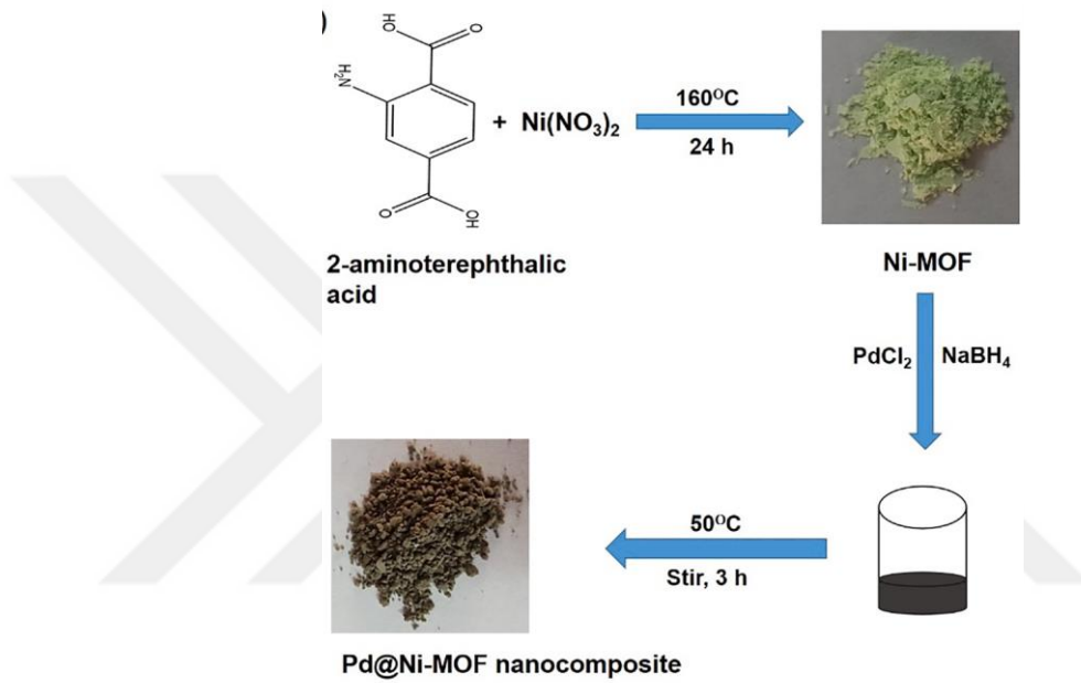
Şekil 2.8 Pd@Ni-MOF nanokompozitinin sentez basamakları
