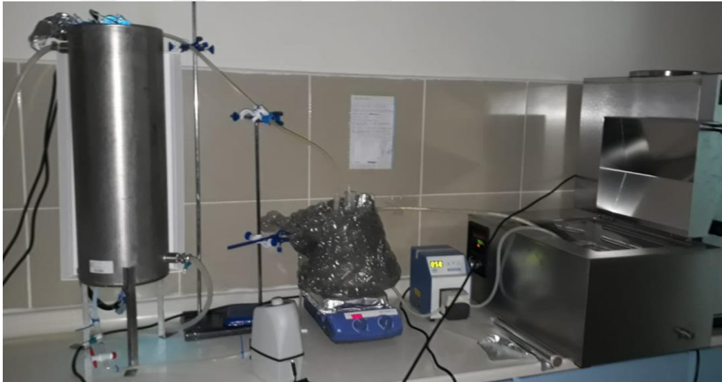
Şekil 3.5 Isıl işlem ile kombine edilmiş sürekli sistem UV-C reaktörü ile pastörizasyon uygulaması
